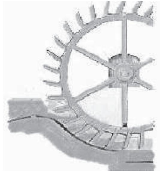
Le moulin « par au dessus » : lorsque l'eau passe par une goulotte et vient frapper en tombant, les augets placés autour de la roue.
